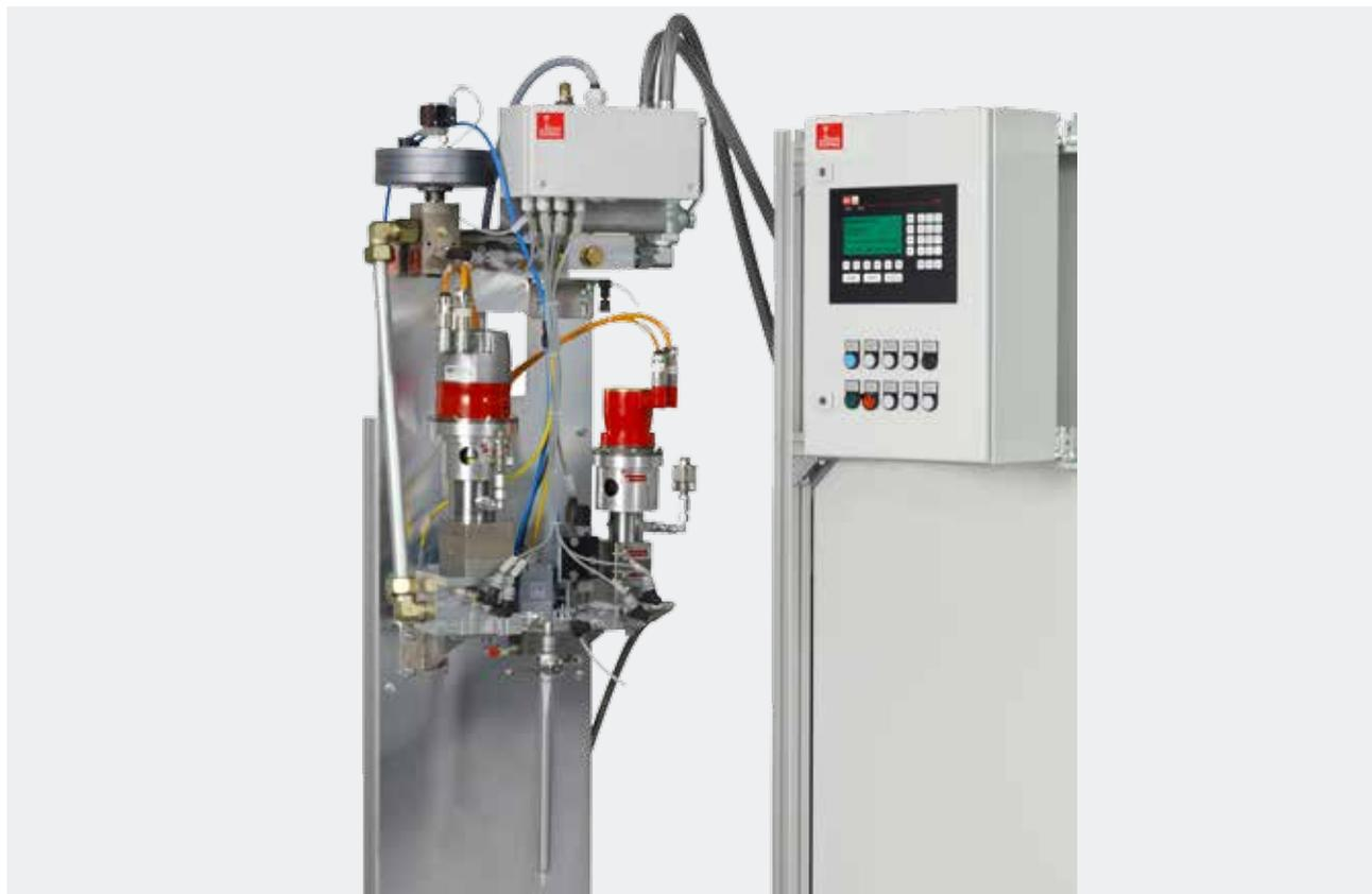
2K-modis用于处理双组份材料。modis兼容性好、模块化设计，只需在混合器出口位置安装混合模块，便能将两台modis单组份系统相连。仅需安装定量装置，并且选择合适的材料供应方式即可。
